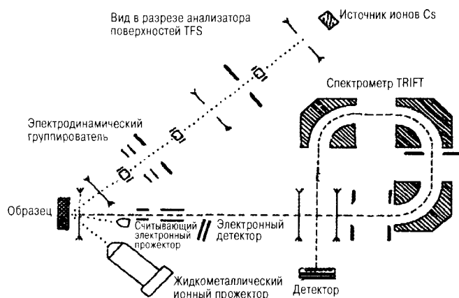
Рис. 15. Схематическое изображение системы времяпролетной SIMS. Оба ионных прожектора работают в импульсном режиме (Charles Evans & Associates)
